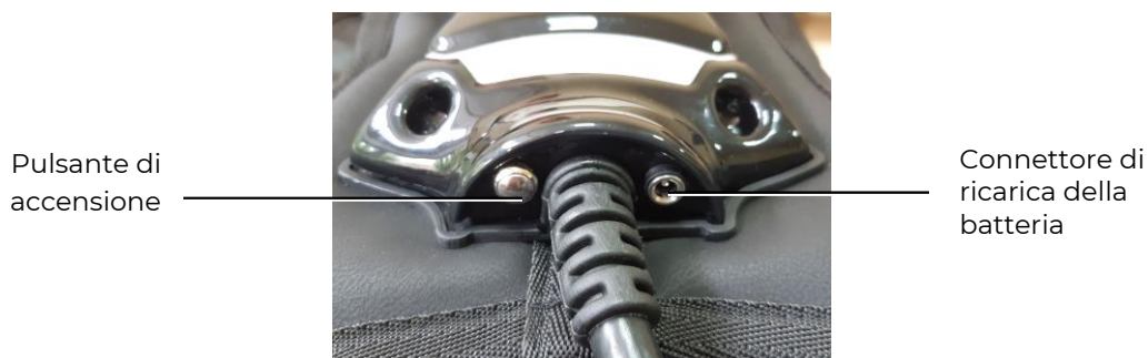
Elementi esterni della centralina
