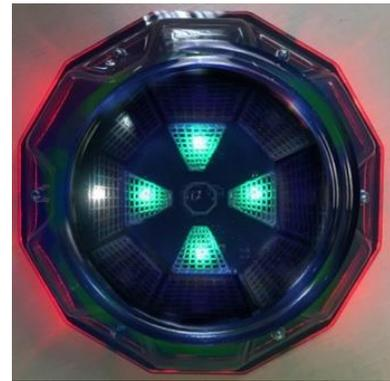
Jede SIRIUS-Station generiert die virtuelle Fahne des eigenen Teams. Dabei leuchten die zentralen LED der Geräte in Farbe des Teams, wobei die weiße LED sich entlang des Außenrings im Uhrzeiger umlaufend dreht. Zeitgleich erteilen die beiden Geräte den Protokollbefehl „Revitalisierung“ via den IR-Kanal und stellen damit die anfänglichen Einstellungen für die deaktivierten Spieler, denen die jeweilige SIRUS-Station gehört.
