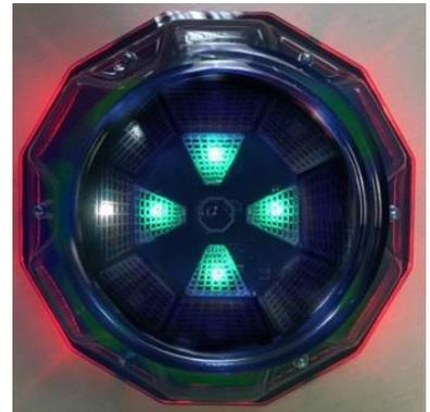
Jede SIRIUS-Station generiert die virtuelle Fahne des eigenen Teams. Dabei leuchten die zentralen LED der Geräte in Farbe des Teams, wobei die weiße LED sich entlang des Außenrings im Uhrzeiger umlaufend dreht. Zeitgleich erteilen die beiden Geräte den Protokollbefehl „Revitalisierung“ via den IR-Kanal und stellen damit die anfänglichen Einstellungen für die deaktivierten Spieler, denen die jeweilige SIRIUS-Station gehört.
