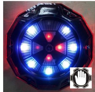
Durch den integrierten Sensor kann der Befehl „Revitalisierung“ zwangsläufig aktiviert werden, ohne dass man auf das Ansprechen des Timers wartet — dies geht mit dem kurzzeitigen Berühren des Gerätegehäuses mit der Handfläche.
