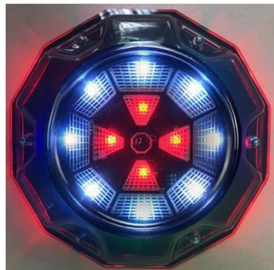
Para desactivar una base extraña, es necesario disparar un cierto número de veces configurado en el escenario. Los impactos se indican mediante el parpadeo frecuente de todos los LED en azul. Después de la desactivación, los LED parpadean, mientras que los externos muestran un temporizador de cuenta regresiva hasta la autore restauración.
