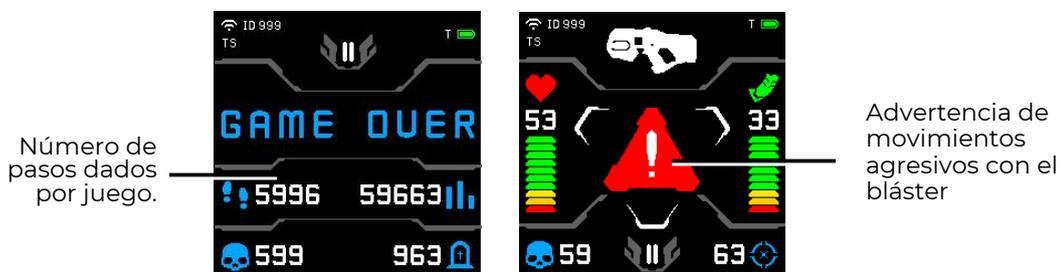
Resultados del giroscopio y el acelerómetro en la pantalla del bláster
