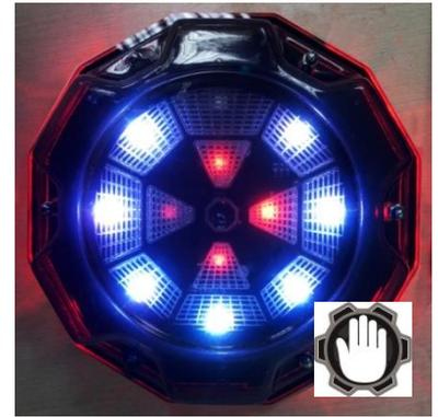
Gracias al sensor incorporado se puede activar el comando "Renacimiento" de manera forzosa sin esperar la respuesta del temporizador - tocando brevemente con la mano la caja de dispositivo.
