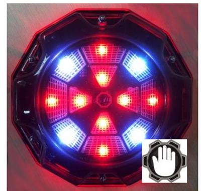
Podrá activar forzosamente el comando "Botiquín" sin esperar la respuesta del temporizador - tocando brevemente con la mano la caja del dispositivo.
