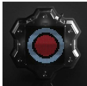
Si un jugador de otro equipo impacta al dispositivo, aparece un círculo del color del segundo equipo en el centro (el círculo del primer equipo no se reestablece) y con los disparos posteriores, el círculo del nuevo equipo comienza a aumentar de tamaño.
