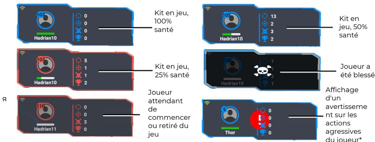
\*L'accéléromètre du blaster détecte les mouvements brusques et dangereux avec le blaster, des informations à ce sujet apparaissent sur l'écran de la tablette de l'instructeur, ainsi que sur l'écran du blaster du joueur (voir paragraphe 1 de ce manuel).
