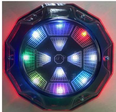
Nach dem Start flackern die LED auf dem Außenring willkürlich auf und die 4 zentralen LED führen die Timer-Funktion aus, d. h. sie leuchte weiß der Reihenfolge nach im Einklang mit der vorgegebenen Zeit und gegen den Urzeigersinn.
