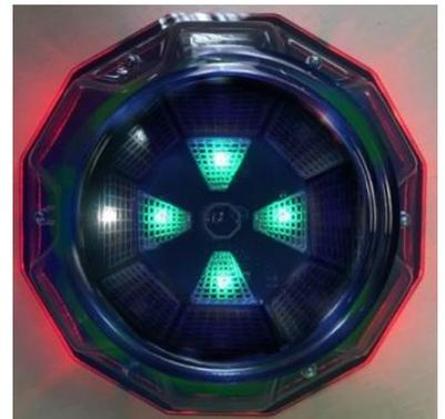
Nach dem Start leuchten die zentralen LED in der Farbe des Teams und die weiße LED „dreht sich“ entlang des Außenrings im Uhrzeigersinn. Wird das Spiel von der Fernbedienung aus gestartet, erteilt das Gerät je 60 Sekunden über den IR-Kanal den Protokollbefehl „Revitalisierung“, bestimmt für die Spieler des jeweiligen Teams (dieser Parameter wird in der Software eingestellt).
