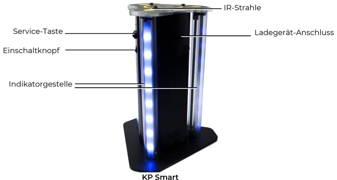
Das Gerät besteht aus einer Unterlage und einem Gehäuse, an dessen Außenseite drei Säulen je mit 16 Smart RGB-LED angebracht sind. Im Gehäuse selbst sind die Buchse für das Ladegerät, der Serviceknopf und EIN/AUS-Knopf vorgesehen. Drei IR-Strahlungserzeuger sind auf dem oberen Deckel angeordnet, die weiteren 3 (drei) sind im oberen Teil des Gehäuses eingebaut. Im Inneren des Gehäuse sind die Elektronikplatine mit der IR-Aufnahmen, der Lautspreche und die Akkus montiert.
