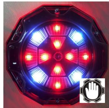
Der LED-Außenring dient als Timer — die LED leuchten in der Reihenfolge gegen den Uhrzeigersinn auf. Sobald die 8 LED leuchtet auf, spricht das Gerät an und lädt den Spielern die bestimmte Menge an Gesundheitsunits nach (wird das Spiel von der Fernbedienung aus gesteuert, erhält ein Spieler 1 zusätzlichen Gesundheitsunit). Dies wird durch das häufige violette Blinken von allen LED begleitet. Dann schaltet sich der Timer wieder ein und der Zyklus läuft erneut.
