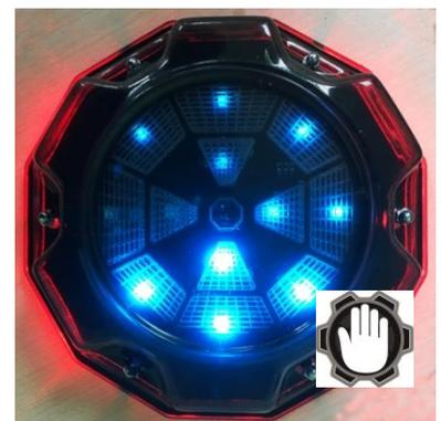
Im Spielmodus „Arsenal“ bleibt der Touch-Sensor aktiv, d. h. wird das Gehäuse kurzzeitig mit der Handfläche gedeckt, wird die Munition außerplanmäßig verteilt.
