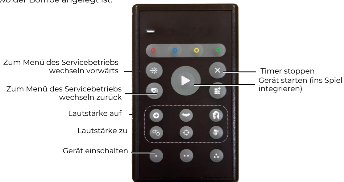
Knöpfe auf der Fernbedienung, zu betätigen bei der Steuerung des Lasertag-Bombes
