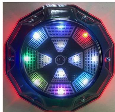
Después del inicio los LEDs por el círculo exterior estallan accidentalmente de diferentes colores y 4 LEDs centrales cumplen la función de temporizador - al tiempo puesto en proporción por turno se iluminan de color blanco en sentido contrario.
