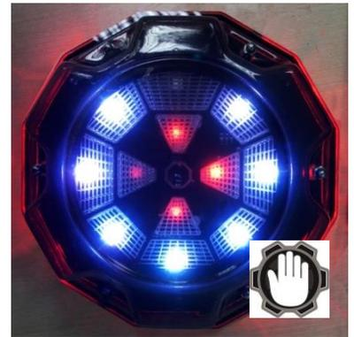
En este modo hay posibilidad de activación forzosa del dispositivo - al cubrir la caja con la mano funcionará el sensor de toque.
