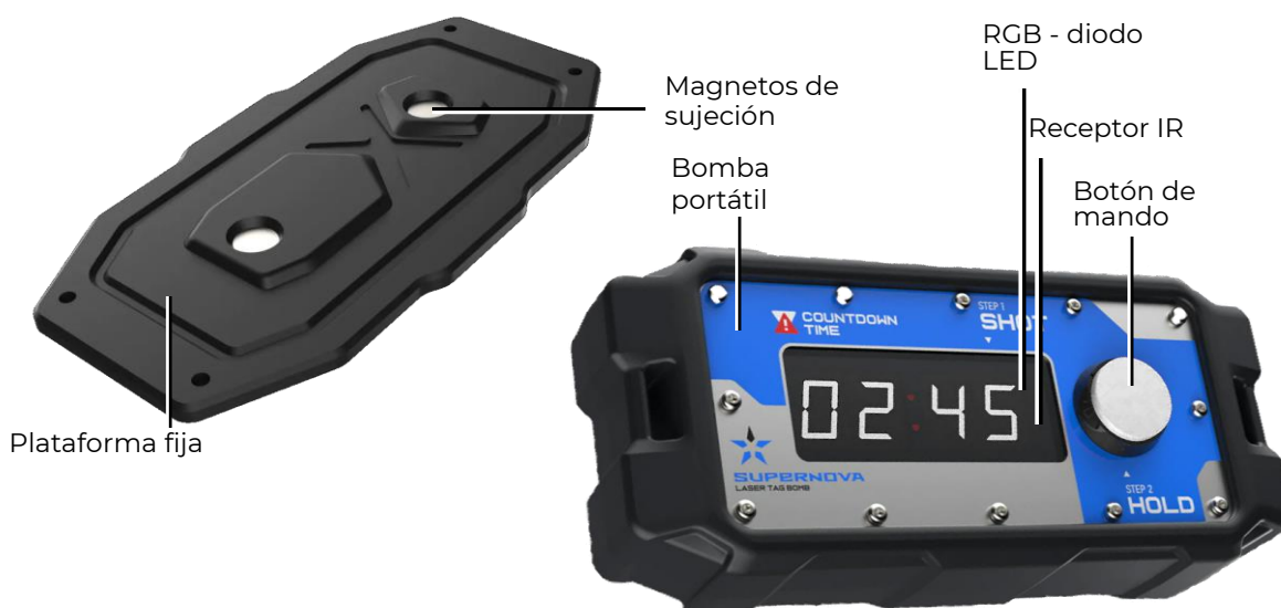
Componentes de bomba lasertag
