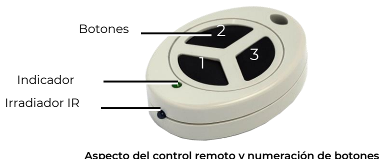
Aspecto del control remoto y numeración de botones
