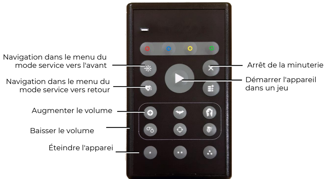
Boutons de la télécommande utilisés pour contrôler la bombe laser tag
